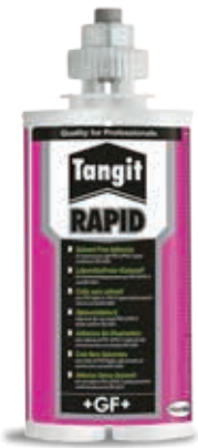
Tangit Rapid是第一款无溶剂粘合剂, 用来粘合聚氯乙烯(PVC-U/C)压力管, 符合欧标EN 14814 和EN ISO 15493。其独特配方不仅完全符合日益严格的化学成分规章, 很多国家也批准将其用于饮用水水管。
