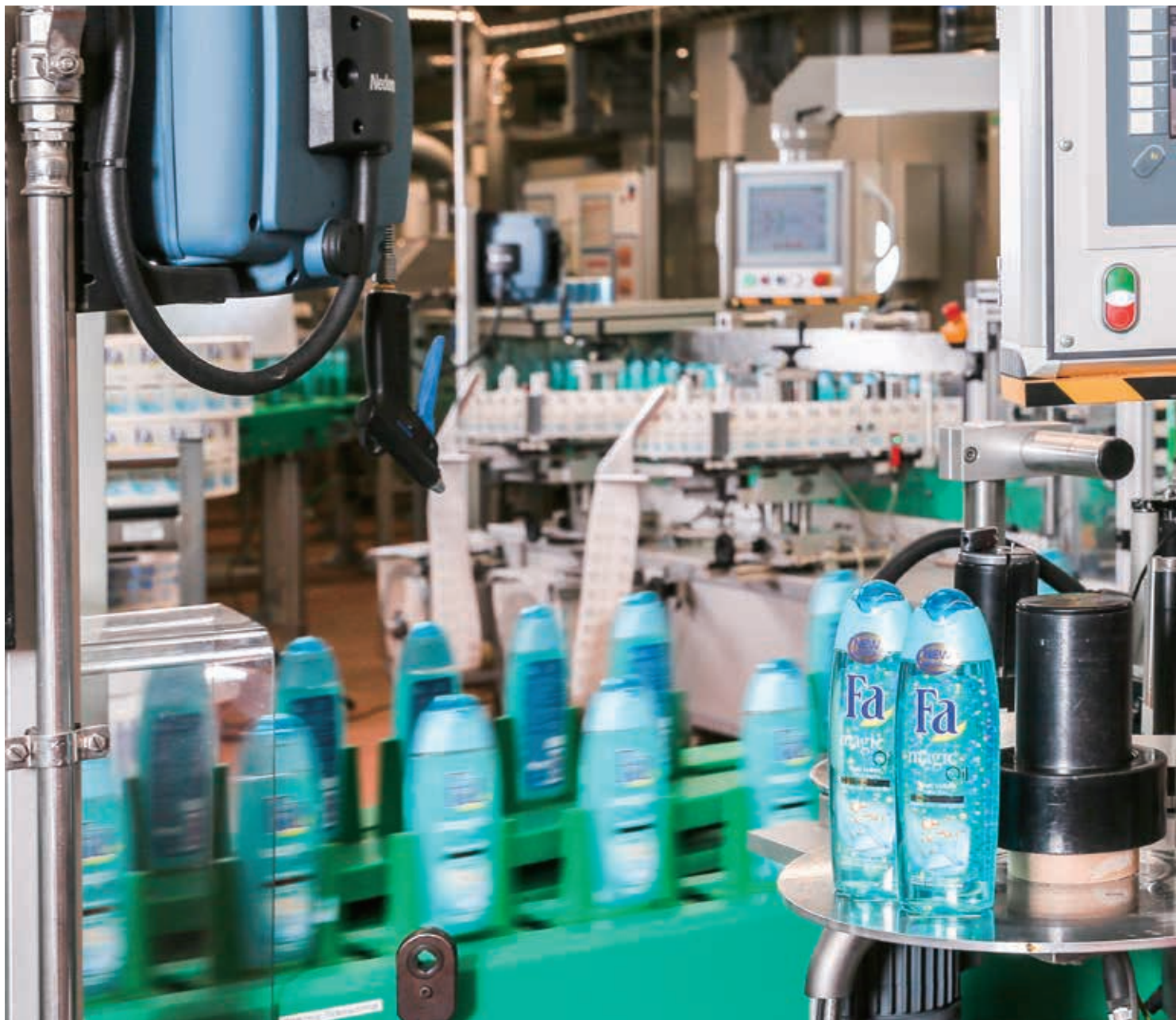
在德国瓦塞尔特吕丁根的工厂里，每分钟能灌装350瓶Fa身体护理品牌沐浴露。得益于在灌装操作中高效的清洗方法，这条生产线的每个清洁周期都能节约超过90%的废水。图为生产线副主管Diana Rathgeb女士检查产品和包装质量。
